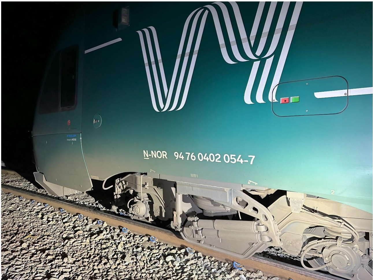
Figur 5: Avsporet front på tog 251. Foto: SHK
