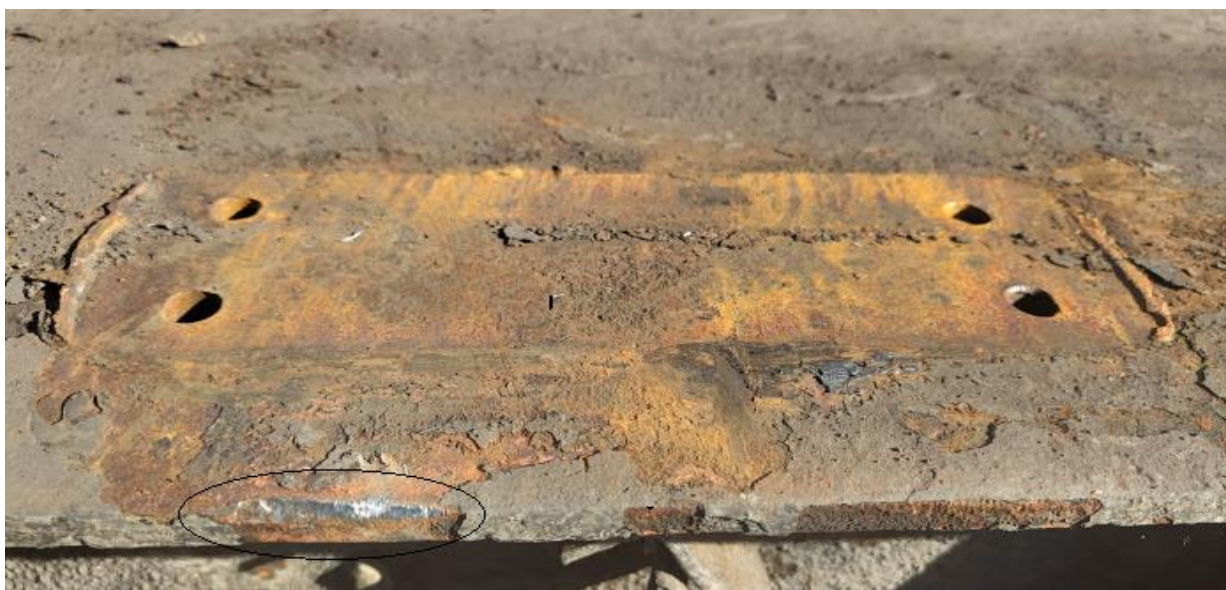
Foto nr.8: Urmă de lovitură recentă pe cadrul boghiului în dreptul pietrei de frezare
