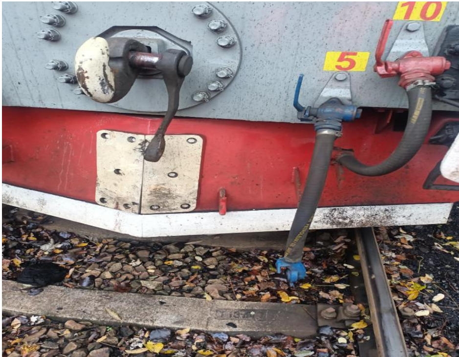
Foto nr.3: bulonul și o eclisă a aparatului de legare în cârligul locomotivei
